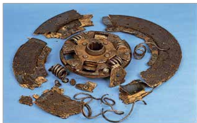
Повреждение диска сцепления
