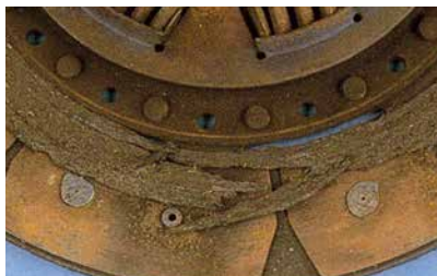
Отслаивание фрикционного материала диска сцепления
